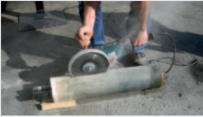
Abb. 5 Auftrennen des Probekörpers mit Diamantsäge
