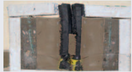
Abb. 10 Schnitt quer durch die Mitte, Bewehrungsgitter im äußeren Verguss sichtbar
