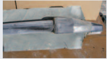
Abb. 7 Verbund des Hinterfüllmörtels am Sondenfuß im Detail
