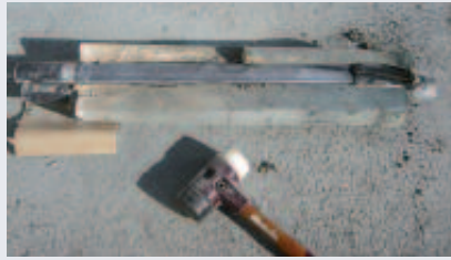
Abb. 6 Prüfkörperhälfte mit eingebetteter Einfach-U-Sonde
